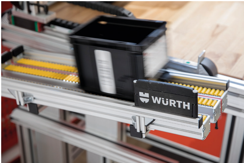
Bild 1: iPLACER® zur Nachschubsteuerung.jpg
